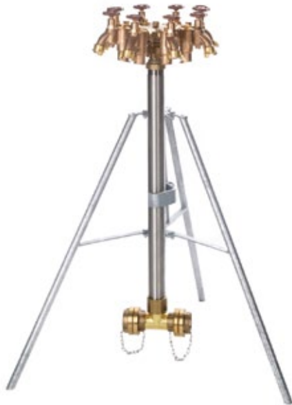
Beispiel: Standrohr mit Dreibein mit 8 Systemtrennern BA DN 20 vorbereitet für Wasserzähler Qn 10
